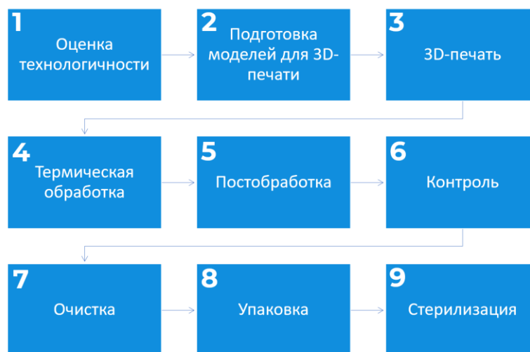
Рисунок 2.14 – Схема технологических процессов создания индивидуального импланта
