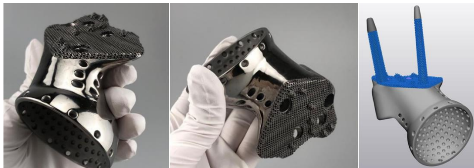
Рисунок 5.8 – Фотографии импланта и компьютерная модель (синим цветом указана пористая поверхность). Поверхность протеза, контактирующая с костью, представлена пористым титаном с дополнительными выступами
