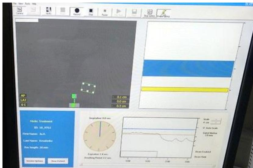
**Рисунок 14** – Интерфейс программы «RPM Respiratory Gating». Слева вверху транслируется изображение с камеры, зелёной рамкой выделен датчик дыхательных движений. Жёлтая полоса справа соответствует положению датчика, синяя полоса – выбранная при топометрической подготовке глубина вдоха. Справа внизу пространство между синей и оранжевой линией соответствует выбранной при топометрической подготовке глубине вдоха, чёрная линия – дыхательной кривой в течение записи
