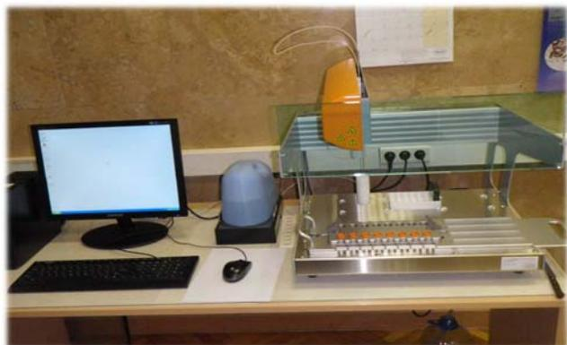
Рис. 1. NOVAprep – аппарат для автоматизированной жидкостной цитологической диагностики NPS.
