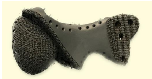
Рисунок 3.13 – Пористая поверхность имплантата в местах соприкосновения с костью
