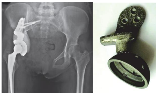
Рисунок 1.5 – Дизайн импланта для реконструкции дефекта вертлужной впадины. Тип резекции P23. Liang H. [80]
