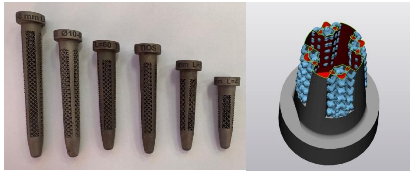
Рисунок 3.12 – Модифицированные трабекулярные штифты
