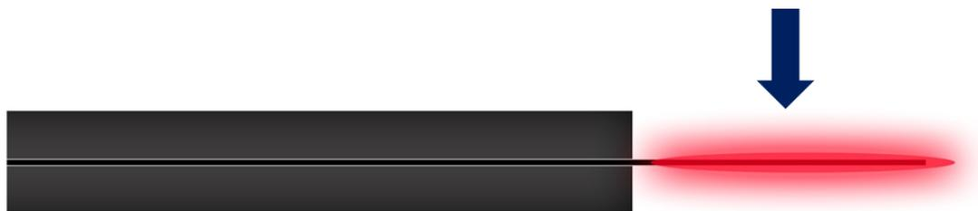
**Рисунок 4** – Устройство №2 для доставки и позиционирования света: световод с цилиндрическим диффузором на конце (синяя стрелка) установлен в эндобилиарный толстостенный интродьюсер
